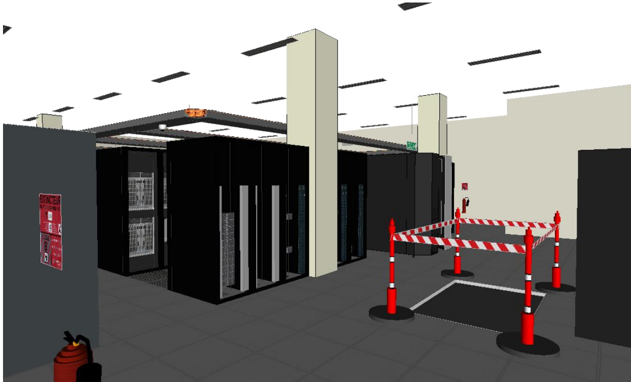
Jumeau numérique pendant une simulation de travaux dans le plancher technique
