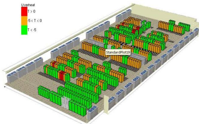
**Cartographie des équipements présentant un risque de surchauffe (en rouge) et ceux dont la température d'entrée d'air est légèrement en dessous de la température limite spécifiée par le constructeur (en orange)**
